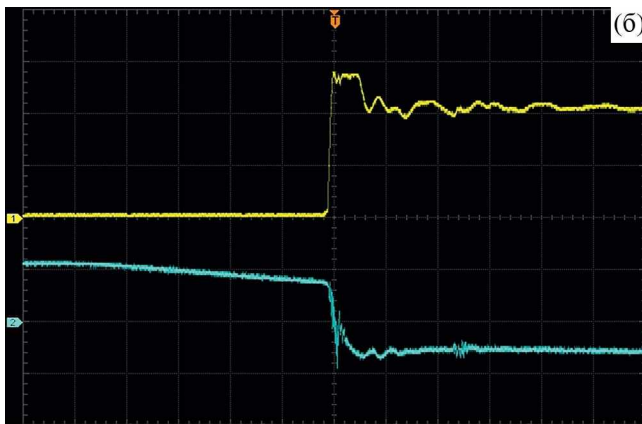
Рис. 6. Осциллограммы напряжения на транзисторе инвертора тока T_2 (верхняя кривая, 200 В/дел) и тока первичной обмотки трансформатора (нижняя кривая, 18.5 А/дел), 10 мкс/дел (а), те же осциллограммы с временной разверткой 1 мкс/дел (б).
