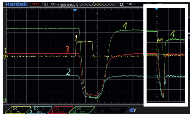
Рис. 6. Осциллограммы напряжений для 3×IGBT: 1 – сигнал на входе драйвера FAN3122, который управляет затвором T_1 (IXBH12N300), 2 – ВВ-импульс на коллекторе T_1 , ВИП подает ЭДС E_1 = 2.3 кВ на нагрузочный резистор R_1 = 1.6 кОм, регистрация высоковольтным пробником 100:1, 3 – ВВ-импульс на коллекторе T_2 (IXBH12N300), ВИП подает ЭДС E_2 = 4.2 кВ на нагрузочный резистор R_2 = 1.6 кОм, регистрация высоковольтным пробником 100:1, 4 – ВВ-импульс на коллекторе T_3 (IXBH12N300), ВИП подает ЭДС E_3 = 6.3 кВ на нагрузочный резистор R_3 = 1.6 кОм, регистрация высоковольтным пробником (1000:1). На вставке: R_1 = R_2 = R_3 = 200 Ом. Скорость развертки по горизонтали 200 нс/дел, масштаб по вертикали 1 кВ/дел.
