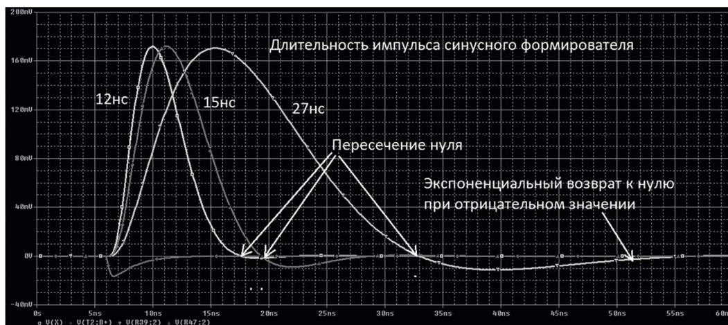
Рис. 7. PSPICE-симуляции импульса синусного формирователя длительностью 12 нс, 15 нс и 27 нс с одним пересечением нулевой линии и возвратом в нуль при отрицательном значении.
