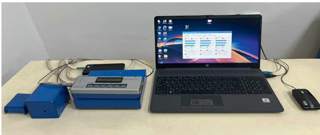
Рис. 3. Радиометрическое устройство для измерения активностей альфа-, бета-, гамма-излучений и объемной активности радона в почве, воздухе, воде одновременно в режиме реального времени.
