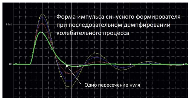
Рис. 5. Эпюры напряжения PSPICE-модели формирователя синусного импульса при различных степенях демпфирования, зеленым цветом показан график, соответствующий ФПК при \beta = 1 .
