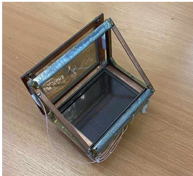
Рис. 2. Позиционно-чувствительный детектор на основе МКП.
