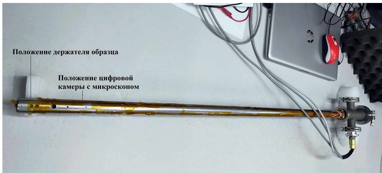
Рис. 1. Вставка с держателем образца и цифровой камерой с микроскопом.
