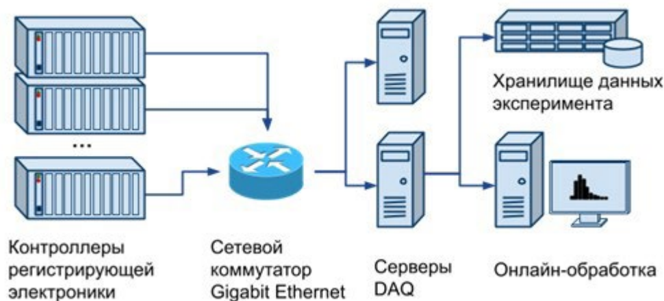
Рис. 9. Архитектура системы сбора данных эксперимента СПАСЧАРМ.
