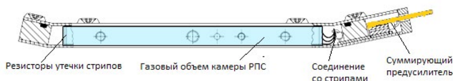
Рис. 6. Рисунок поперечного разреза камеры МРПС, расположение суммирующего предусилителя.
