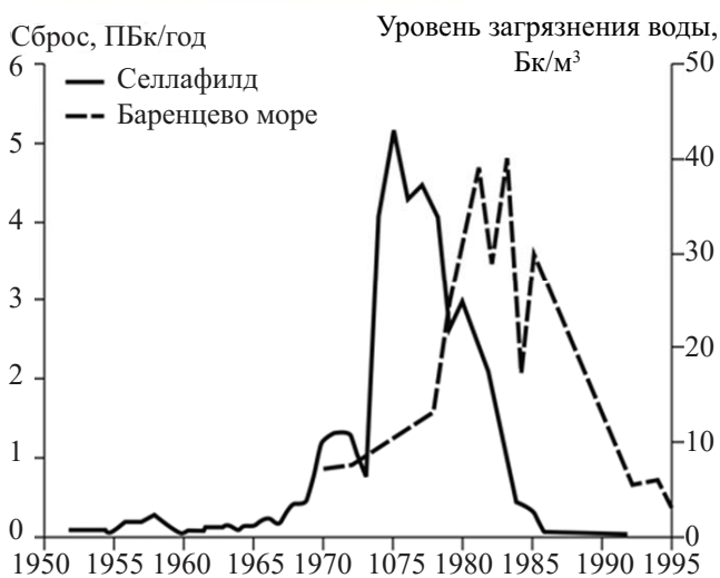
Рис. 11. Зависимость уровня загрязнений морской воды Баренцева моря ( \text{Bк}/\text{м}^3 ) от объемов сбросов радионуклидов – продуктов деления от радиохимического производства Селлафилд (Великобритания, \text{PBк}/\text{год} ) за счет их переноса течением Гольфстримом (1950–1995 гг.)
