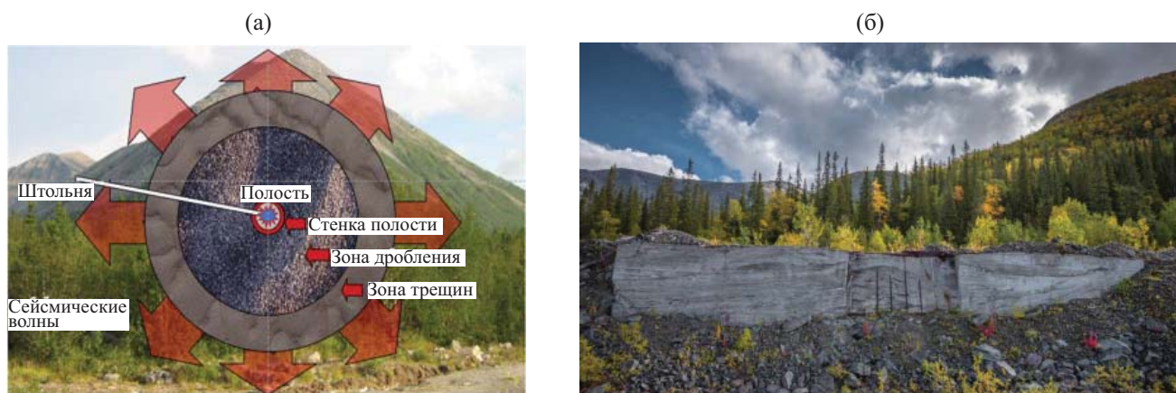
Рис. 14. Мирные ядерные взрывы (МЯВ) «Днепр-1» (04.09.1972) и «Днепр-2» (27.08.1984) в Хибинах: (а) – Принцип использования МЯВ как метод дробления апатитовой руды; (б) – замурованная горная шахта от МЯВ «Днепр-2» (фото А. Ма- раховец, https://www.drive2.ru/c/573015433691529288/ )
