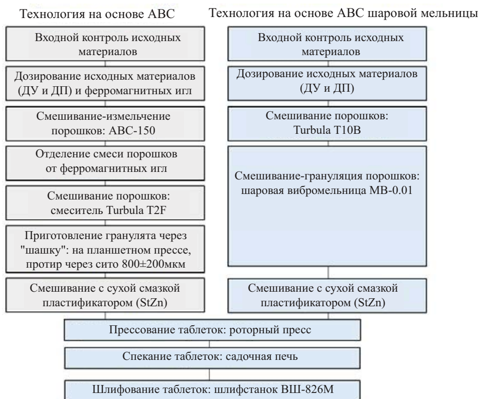
Рис. 7. Аппаратурно-технологическая блок-схема изготовления таблеток РЕМИКС-топлива на ГХК.
