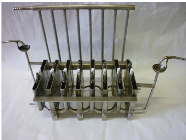
Рис. 4. Лабораторный экстракционный блок типа «смеситель—отстойник».
