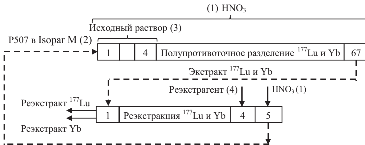
Рис. 1. Принципиальная технологическая схема экстракционного выделения ^{177}\text{Lu} .
