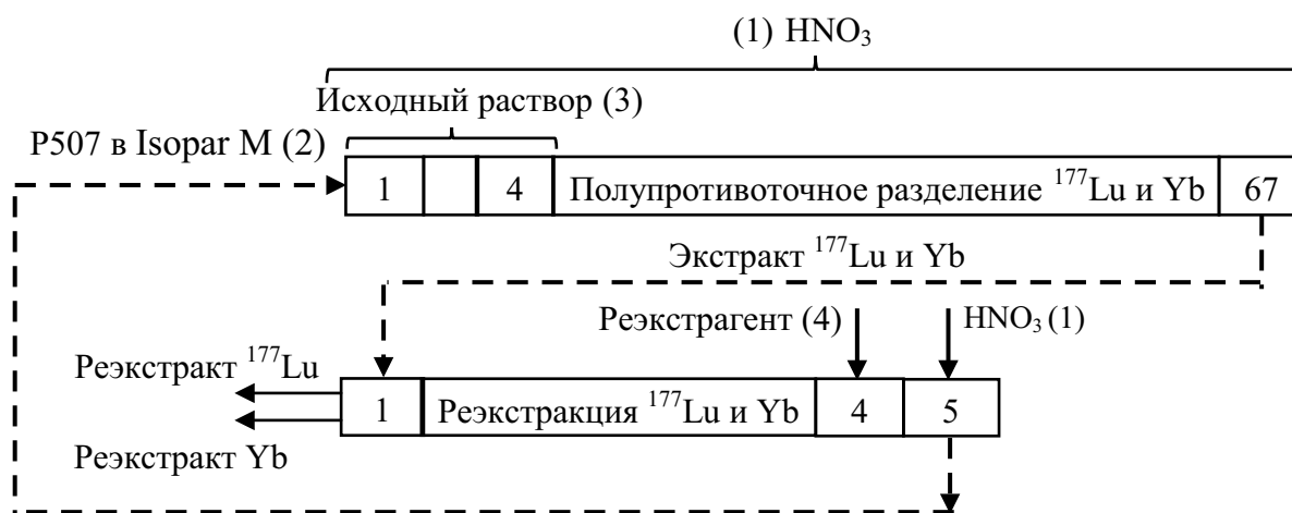
Рис. 1. Принципиальная технологическая схема экстракционного выделения ^{177}\text{Lu} .
