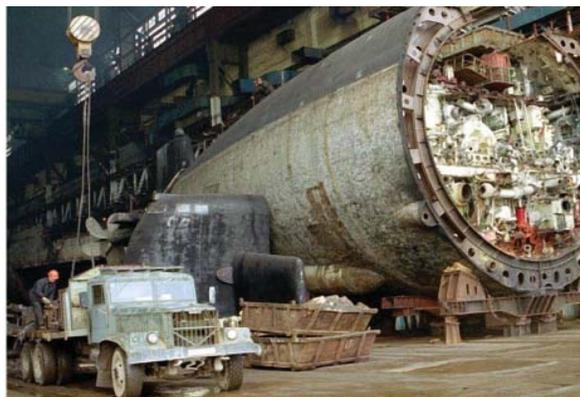
**Рис. 5.** Рабочие моменты на этапах вывода из эксплуатации 120 из 126 АПЛ первого и второго поколения, выведенных из состава Северного флота; на 2023 год 4 АПЛ ожидают утилизации, а по затопленной АПЛ Б-159 решение не принято.
