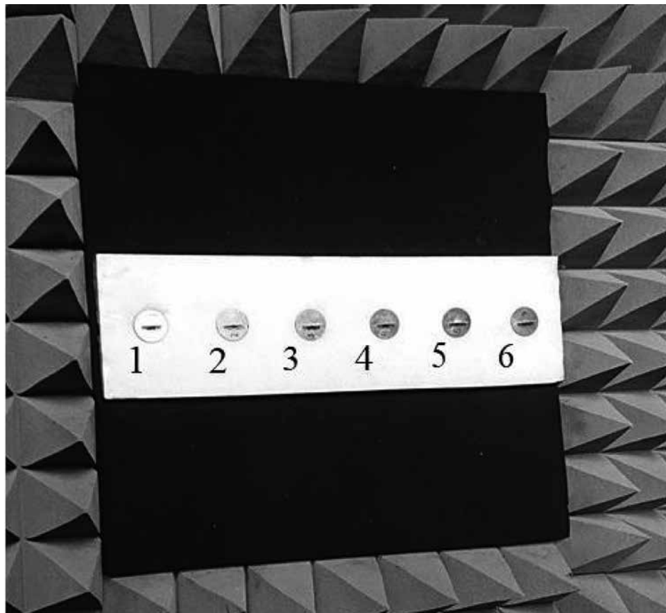
Рис. 5. Излучатели матричного имитатора: 1...6 – антенны.
