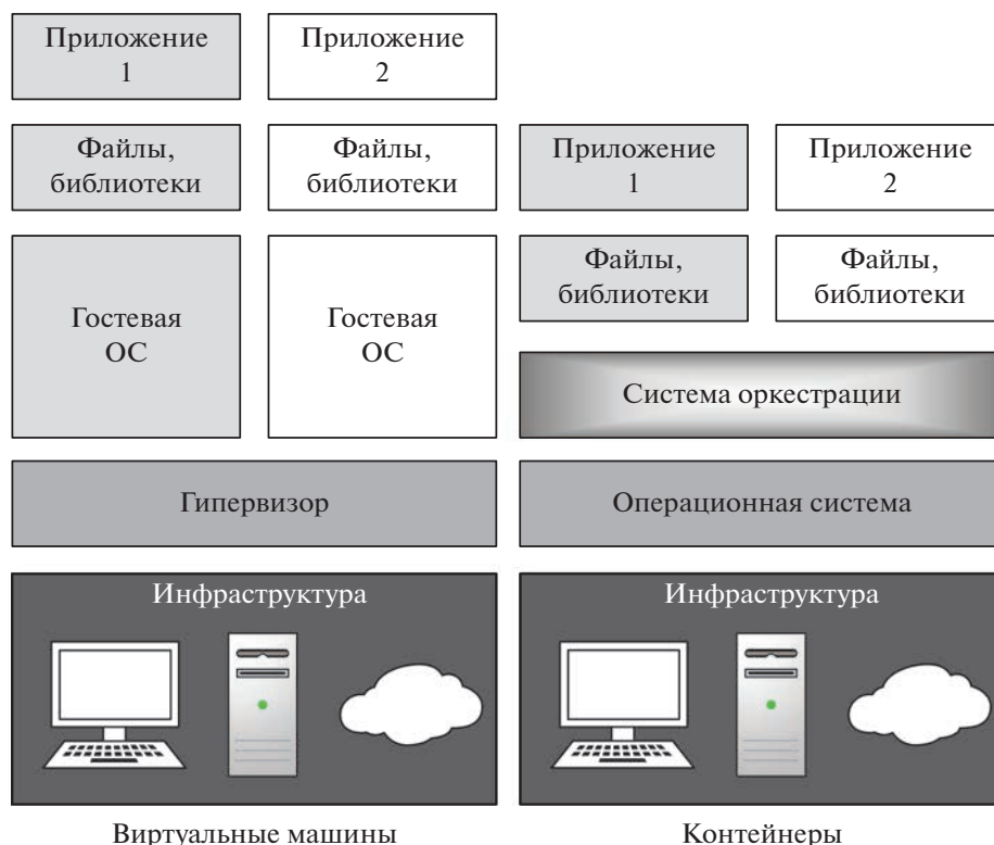
Рис. 1. Схема организации микросервисной архитектуры на основе виртуальных машин и контейнеров. ОС — операционная система.
