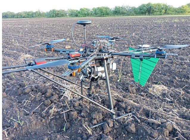
Рис. 3. Внешний вид БПЛА-рефлектометра.
