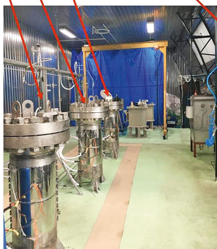
Рис. 13. Внешний вид пилотной установки с аппаратами высокого давления объемом 70 л.
