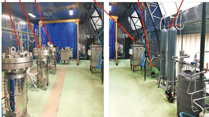
**Рис. 13.** Внешний вид пилотной установки с аппаратами высокого давления объемом 70 л.
