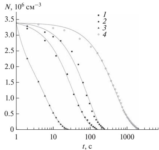
Рис. 3. Зависимость от времени концентрации капель аэрозоля при резонансной частоте  $f_1 = 64$  Гц и различных значениях амплитуд смещения поршня: 1 –  $l = 0.25$  мм, 2 – 0.5, 3 – 1.5, 4 – при естественном осаждении ( $l = 0$ ); кривые – показательная функция.
