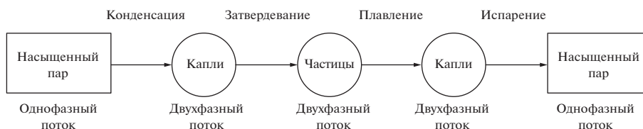
Рис. 2. Иллюстрация роли фазовых превращений при переходе системы из однофазного состояния в двухфазное и обратно [4].
