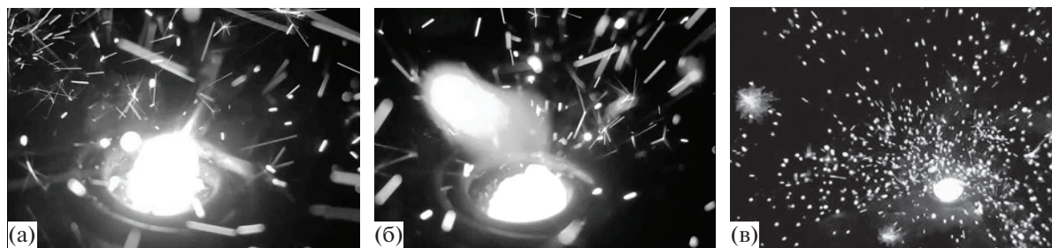
Рис. 3. Фотографии эмиссии жидкометаллических капель из стали ШХ15: (а) — T = 1900 К, скорость съемки — 250 кадр/с; (б) — >2000 К, 250 кадр/с; (в) — 1900 К, 960 кадр/с.
