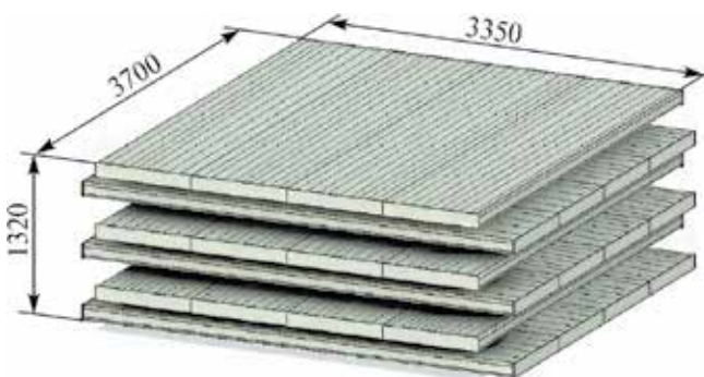
Рис. 1. Эскиз и размеры годоскопа.
