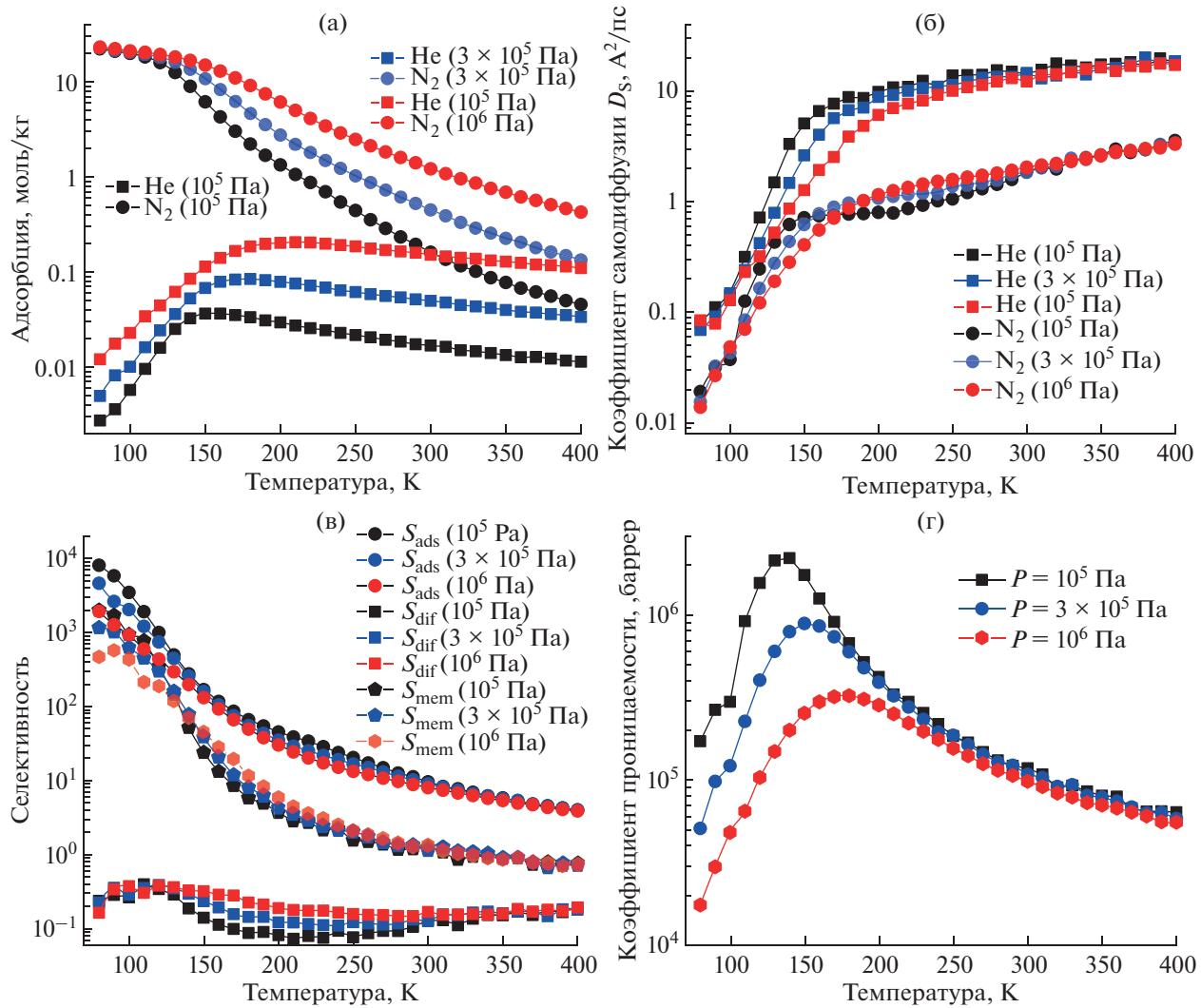
Рис. 2. Температурная зависимость расчетных величин адсорбции (а), коэффициентов самодиффузии (б), селективностей (в) и коэффициентов проницаемости по азоту (г) для эквимолярной смеси N<sub>2</sub> и He в структуре HKUST-1 при давлениях 0.1, 0.3 и 1 МПа в диапазоне температур от 80 до 400 К.
