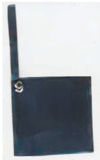
Рис. 1. Внешний вид стального образца, используемого при проведении электрохимических исследований.
