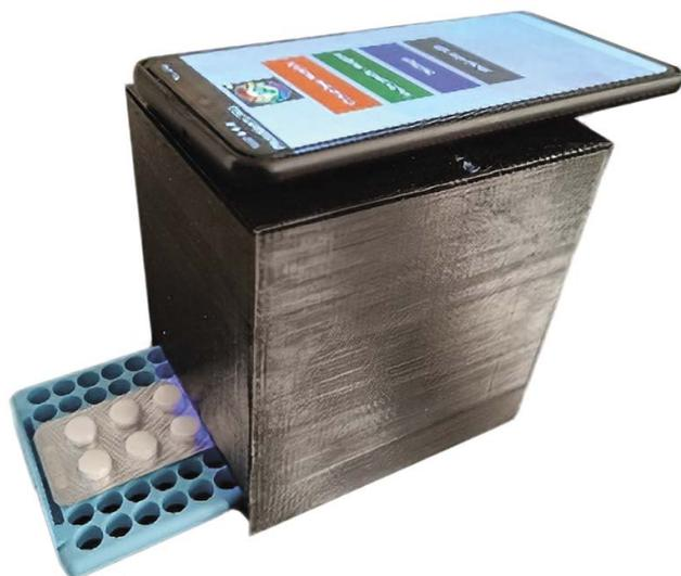
Рис. 1. Устройство для цветометрического анализа.
