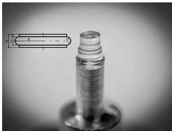
Рис. 1. Фотография микрорезонатора из MgF_2 . На вставке схематично представлена геометрия МШГ-микрорезонатора: H — высота резонатора, R — радиус резонатора, I — отступ от края, r — радиус закругления резонатора, C — хорда
