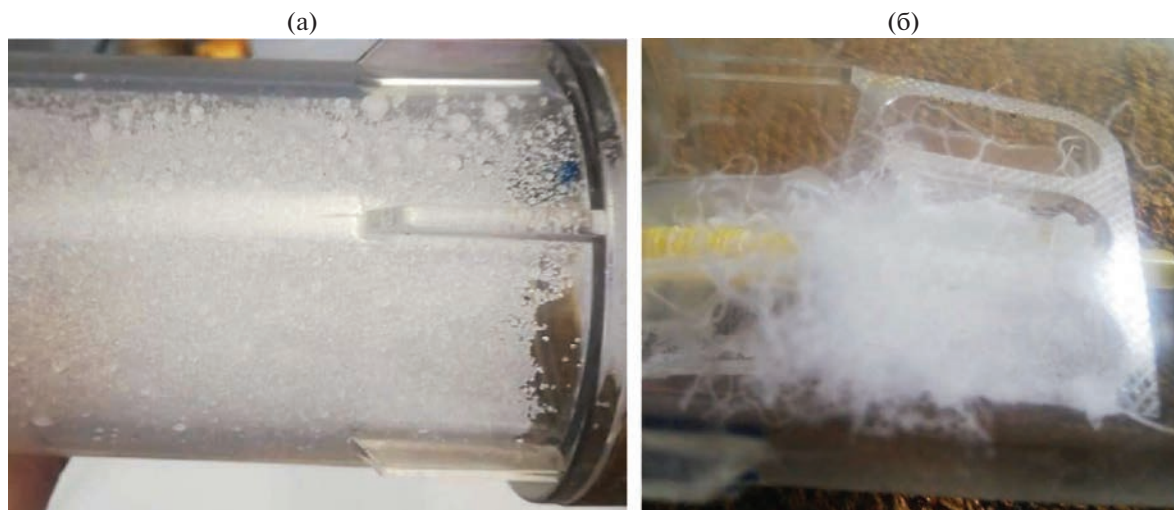
Рис. 2. Примеры образования гидрата ксенона без контакта с жидкой водой; а — видны кристаллы гидрата, выросшие на верхней поверхности камеры; б — видны нитевидные висцерные кристаллы, выросшие в объеме камеры.
