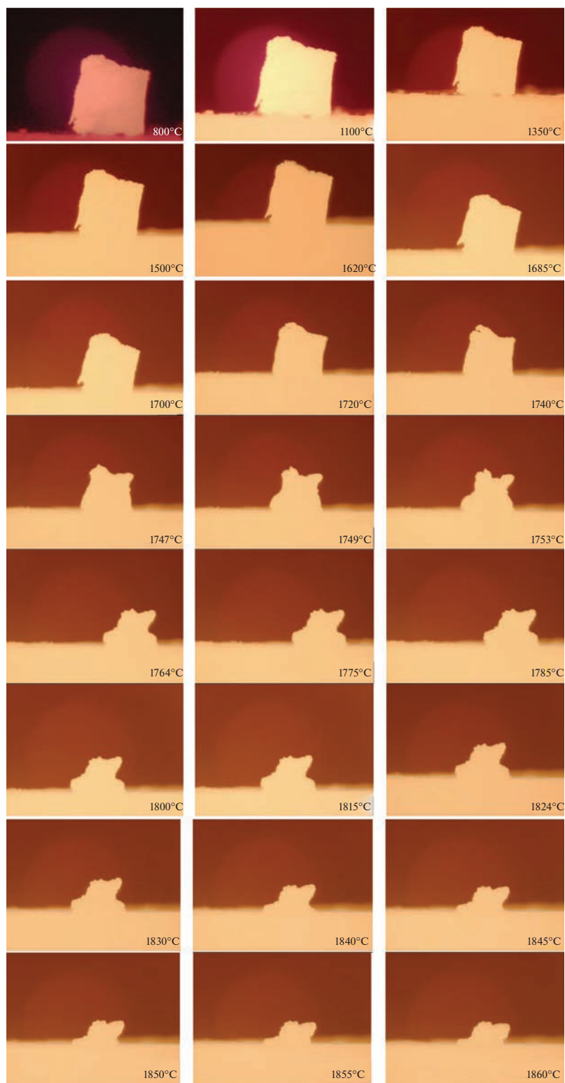
Рис. 5. Плавление оксидной композиции \text{Al}_2\text{O}_3-(t+m)\text{ZrO}_2(\text{Y}_2\text{O}_3) на подложке SiC.
