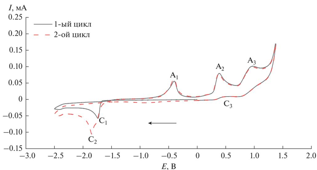
**Рис. 4.** ЦВА-кривые комплекса **1**. Развертка потенциала от 0.00 до  $-2.50$  В, обратно до 1.40 В и далее до 0.00 В (сплошная линия); второй цикл от 0.00 до  $-2.50$  В, обратно до 1.40 В и далее до 0.00 В (пунктир).
