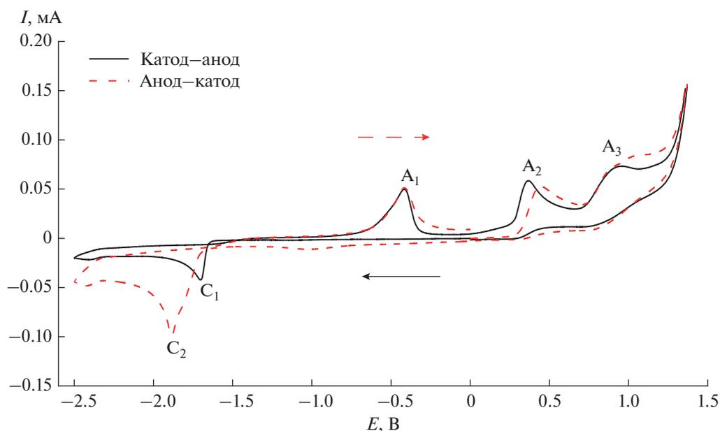
Рис. 2. ЦВА-кривые комплекса **1**. Развертка потенциала рабочего электрода от 0.00 до  $-2.50$  В, обратно до  $1.40$  В и далее до  $0.00$  В (сплошная линия); от  $0.00$  до  $1.40$  В, далее до  $-2.50$  В и обратно до  $0.00$  В (пунктир).
