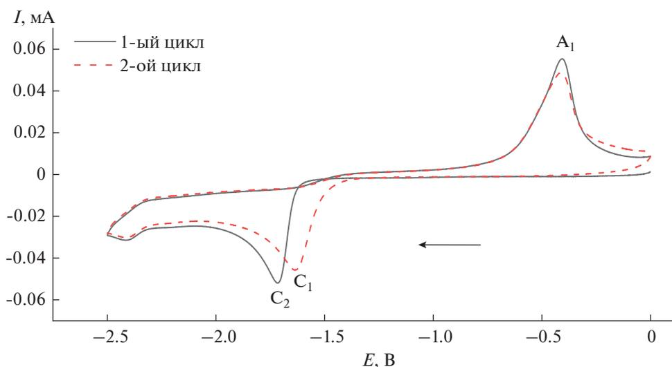
**Рис. 3.** ЦВА-кривые комплекса **1**. Развертка потенциала рабочего электрода от 0.00 до  $-2.50$  В, обратно до 0.00 В (сплошная линия); второй цикл от 0.00 до  $-2.50$  В, обратно до 0.00 В (пунктир).
