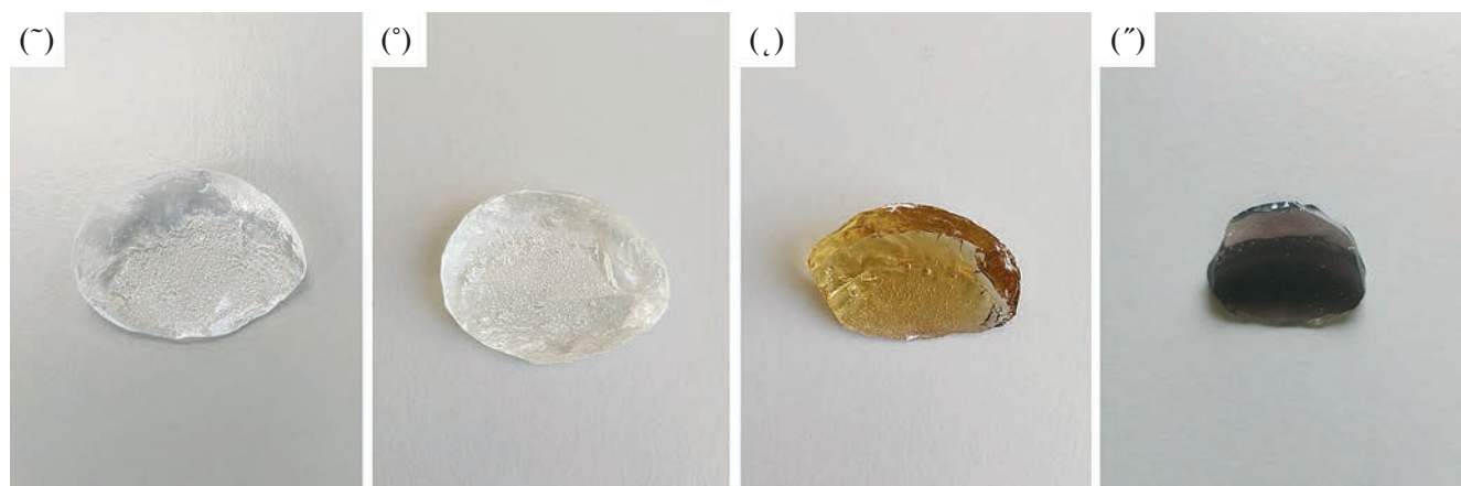
Рис. 2. Фотографии образцов, легированных \text{Bi}_2\text{O}_3 , мас. %: 5 (а), 10 (б), 20 (в), 40 (г)
