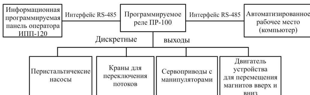
Рис. 1. Схема подключения устройств управления автоматизированной установкой для онлайн-концентрирования с применением магнитных сорбентов.
