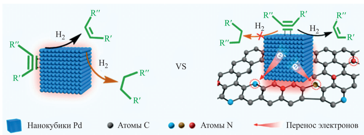
Рис. 5. Схема гидрирования алкинов на поверхности ненанесенных и нанесенных Pd NCs [113]. 1
