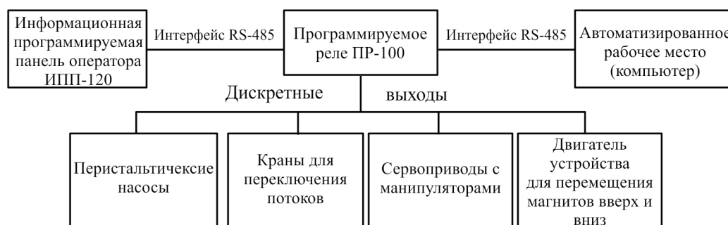
Рис. 1. Схема подключения устройств управления автоматизированной установкой для онлайн-концентрирования с применением магнитных сорбентов.
