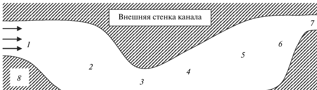
Фиг. 1. Общая схема расчетной области: 1 — входная область, 2 — форкамера, 3 — горловина, 4 — диффузор, 5 — рабочая камера, 6 — конфузор, 7 — выходная область, 8 — центральное тело.
