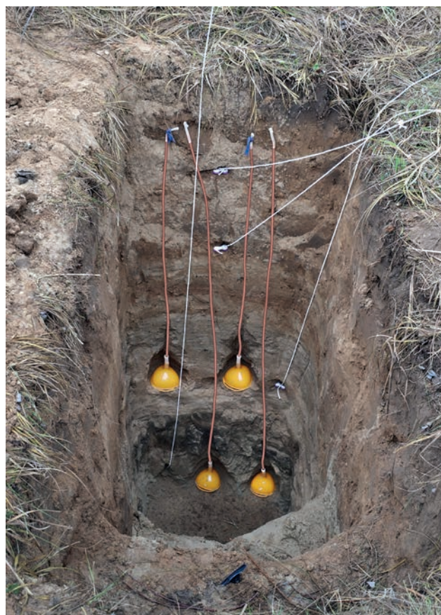
Рис. 3. Общий вид установленных в шурфе систем отбора проб грунтового воздуха (желтые воронки, медные трубки) и измерения температур (белым шпагатом привязаны логгеры для облегчения их поиска при изъятии).
