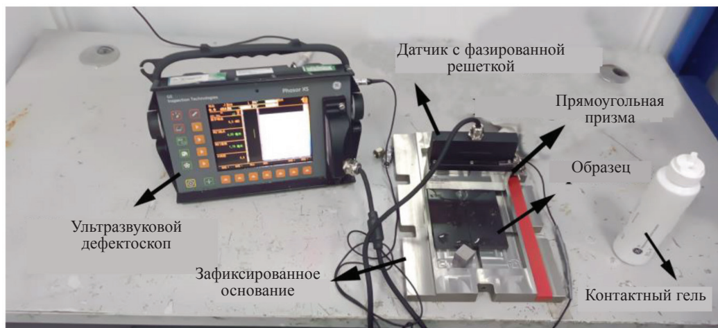
Рис. 3. Установка для ультразвукового контроля фазированными решетками.
