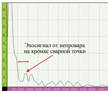
Рис. 10. А-скан, полученный на кромке сварного соединения образца № 2.
