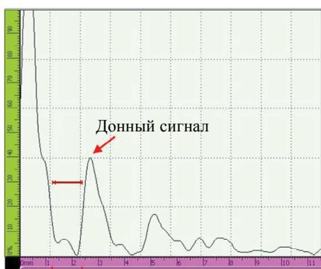
Рис. 8. А-скан, полученный на бездефектном образце.
