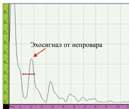
Рис. 9. А-скан, полученный на образце № 1 с непроваром.
