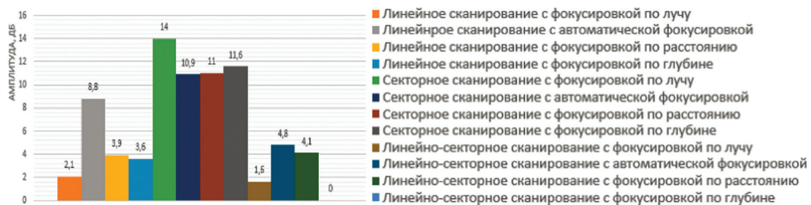
Рис. 8. Сравнение амплитуд эхосигналов от непровара при работе с ФАР на разных типах фокусировки и сканирования.
