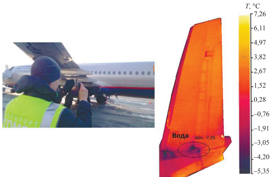
Рис. 1. Пассивная диагностика влагосодержания в руле направления самолета Boeing-737 после посадки с помощью тепловизионного модуля ThermApp (обследование НИ ТПУ в 2018 г., аэропорт г. Томска [6]).
