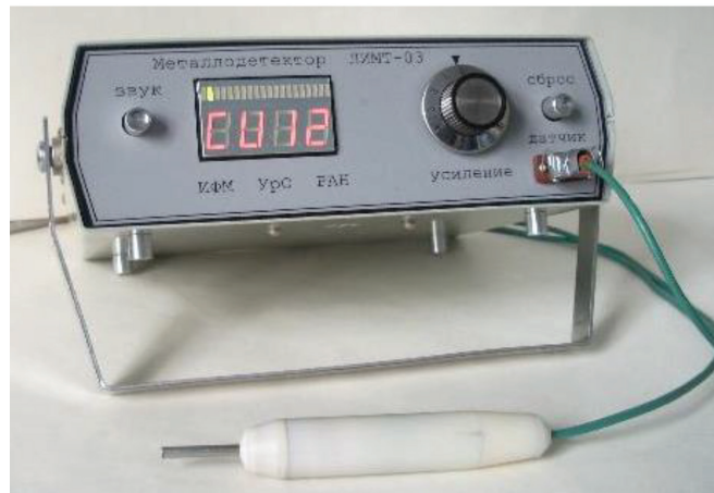
Рис. 8. Вихретоковый металлоискатель для поисков в теле человека инородных частиц из цветных металлов.
