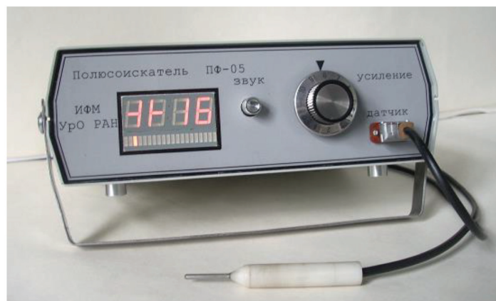
Рис. 6. Медицинский феррозондовый полюсоискатель ПФ-05.
