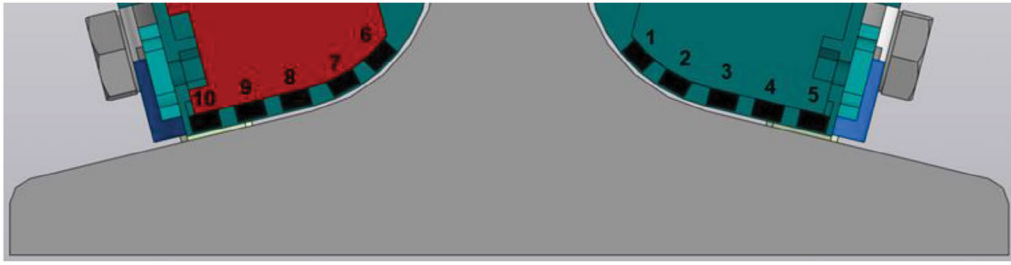
Рис. 10. Размещение датчиков Холла по поверхности перьев подошвы.
