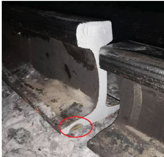
Рис. 1. Пример излома рельса из-за поперечной трещины, развивающейся в пере подошвы.
