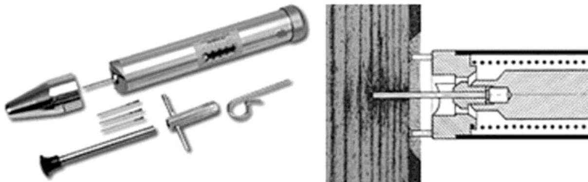
Рис. 2. Пенетрометр и принцип его действия.
