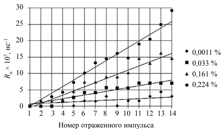
Рис. 7. Зависимость параметра «ускорения» R_n от номера отраженного импульса.
