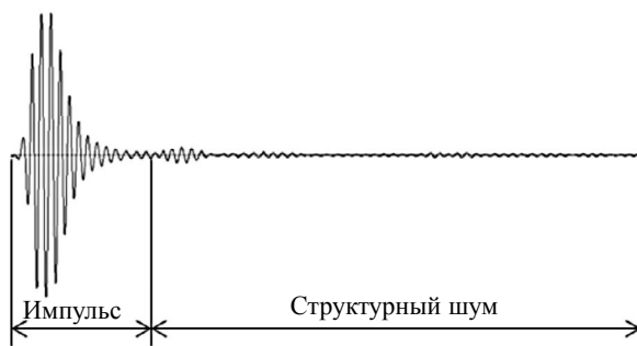
Рис. 3. Типичная осциллограмма для образца с содержанием водорода 0,161 мас. %.
