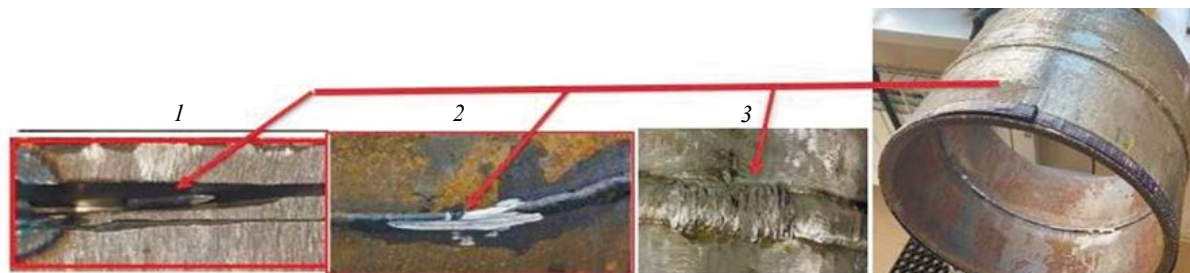
Рис. 1. Изготовление КСС с характерными дефектами: 1 — непровар в корне; 2 — несплавление по разделке; 3 — цепочка внутренних пор.
