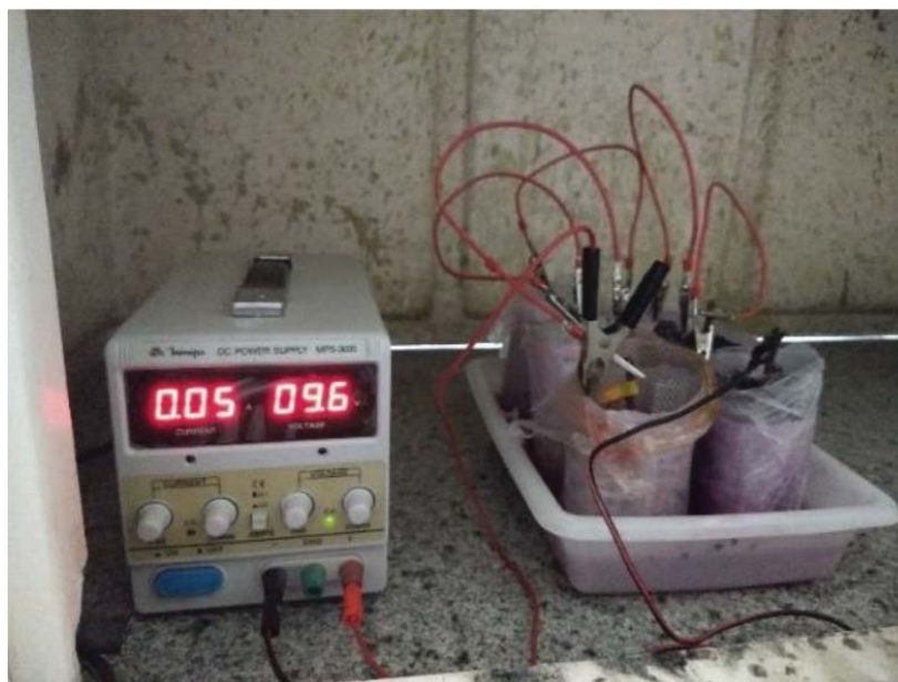
Рис. 3. Система для реалкализации: смесь А — 0,5 А/м 2 .
