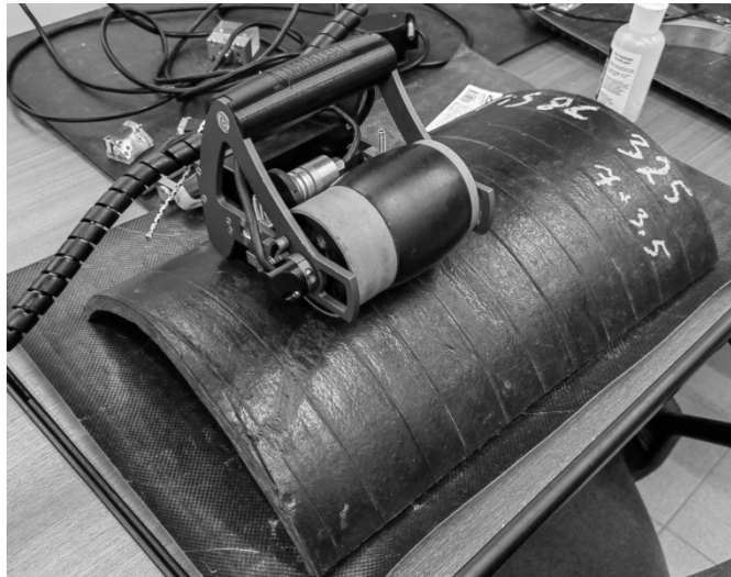
Рис. 1. Роликовый фазированный датчик с матрицей на 64 элемента.
