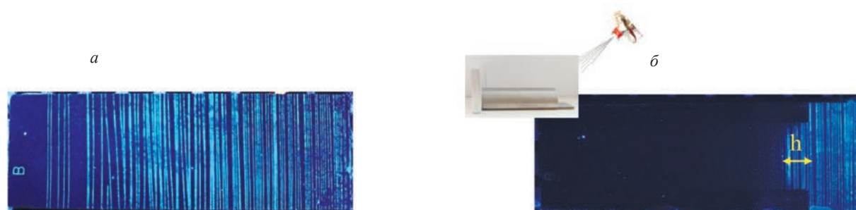
Рис. 5. Результаты капиллярного контроля образца типа 1 по ГОСТ Р ИСО 3452—3 или ISO 3452-3 с дефектами в составе разборного образца (б) и отдельно (а).
