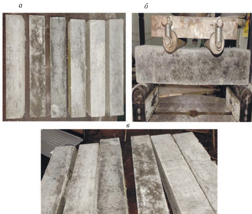
Рис. 4. Образец из бетона размерами 100×100×500 мм (а); образец, загруженный в универсальную испытательную машину (б); изображения образцов с трещинами (в).
