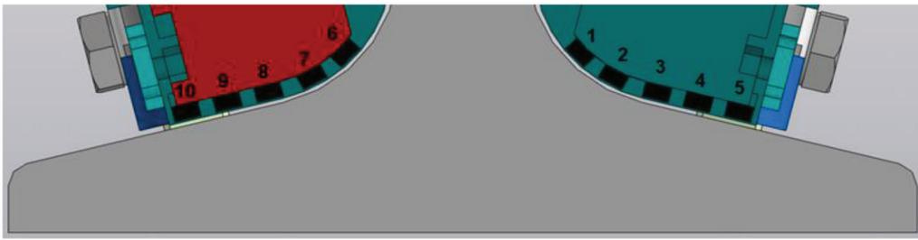
Рис. 10. Размещение датчиков Холла по поверхности перьев подошвы.
