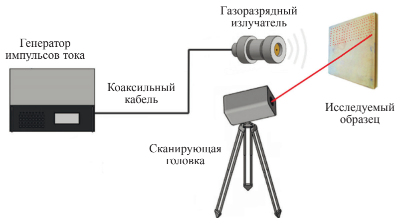
Рис. 3. Упрощенная схема лабораторной установки для проведения НК с использованием сканирующей лазерной доплеровской виброметрии и бесконтактного способа стимуляции материалов на основе ГЭАП.
