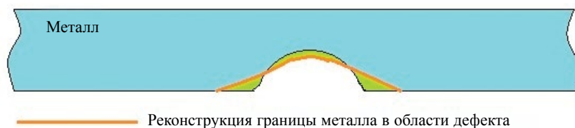
Рис. 3. Поперечное сечение пластины с реконструкцией границы металла в области дефекта, полученное в результате решения обратной геометрической задачи.
