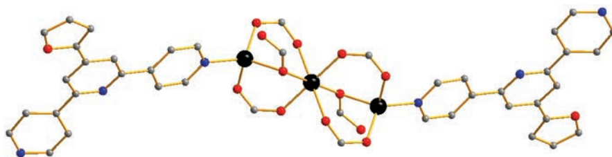
Рис. 1. Строение трехъядерного фрагмента \{Zn_3(Bdc)_6(FurTerPy)_2\} . Здесь и далее Zn черный, O красный, C серый, N синий, атомы H опущены. Отображены только карбоксилатные группы Bdc-лигандов.
