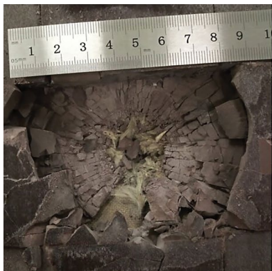
Рис. 2. Фотографии панелей на основе керамики после воздействия индентора: a – корунд, б – керамика «Идеал».
