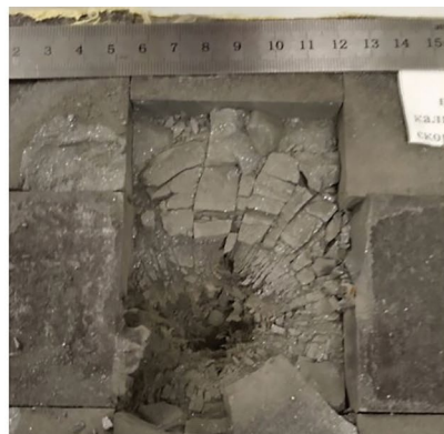
Рис. 2. Фотографии панелей на основе керамики после воздействия индентора: a – корунд, б – керамика «Идеал».
