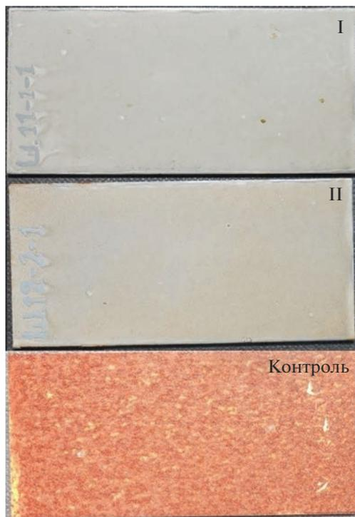
Рис. 4. Внешний вид покрытий I, II и контрольного образца после экспозиции в течение 6 мес. на открытом испытательном стенде в г. Ханой.
