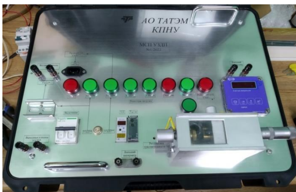
Рис. 5. Устройство для проверки аппаратов защиты от последовательного и параллельного дуговых пробоев и искровых промежутков
