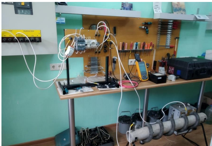
Рис. 7. Испытательная установка для тестирования УЗДП на эффективность срабатывания при параллельном дуговом пробое
