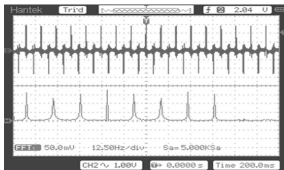
Рис. 4. РАП и результат его БПФ на дисплее осциллографа при N = 16
