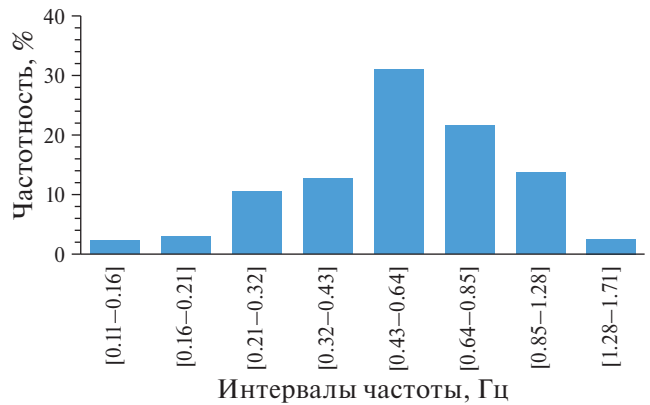
Рис. 3. Гистограмма распределения ширины экспертного диапазона частот, содержащего допустимое значение верхней границы шума для оптимальной фильтрации.
